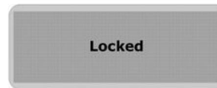
Verschieben Sie den Schalter HOLD in Pfeilrichtung. Sobald HOLD aktiviert ist, sind alle Tasten gesperrt und funktionieren nicht.
